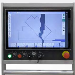
**HACO EASYBEND** è un sistema di controllo avanzato per presse piegatrici, che combina un potente software 2D e hardware basato su PC per offrire elevata precisione e flessibilità. I programmi possono essere creati direttamente sulla macchina, manualmente o automaticamente, oppure generati tramite software offline. Progettato per garantire l'affidabilità, integra l'assegnazione degli utensili, le sequenze di piegatura e la programmazione CNC per garantire prestazioni ottimali.
