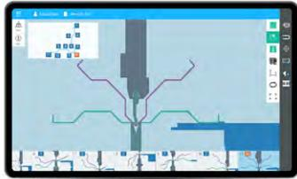
Anteprima dei passaggi: capacità di visualizzare i passaggi di piegatura.
