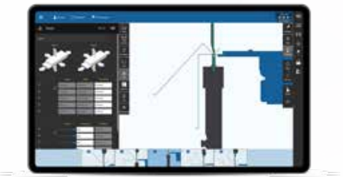
Sequenza di piegatura automaticamente definita. Per ogni passaggio, l'unità di controllo calcola le posizioni di ciascun asse.
