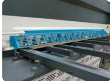
Bracci di squadratura e bracci di supporto anteriori con o senza scala, scanalatura a T e fermo a scomparsa. Lunghezze da 1000 a 3000 mm per lunghezze multiple di 500 mm.
