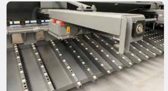
Il registro posteriore è costituito da 2 bracci rigidi (contenenti guide e viti a sfere) e dalla barra parallela regolabile del registro posteriore. Questo gruppo assicura un posizionamento preciso del foglio. Posizionamento programmabile con il controllo SC200. Lettura digitale della posizione effettiva e preselezionata o programmata. Il registro posteriore a scomparsa consente il taglio di fogli più lunghi della lunghezza della corsa standard, su viti a sfere.
