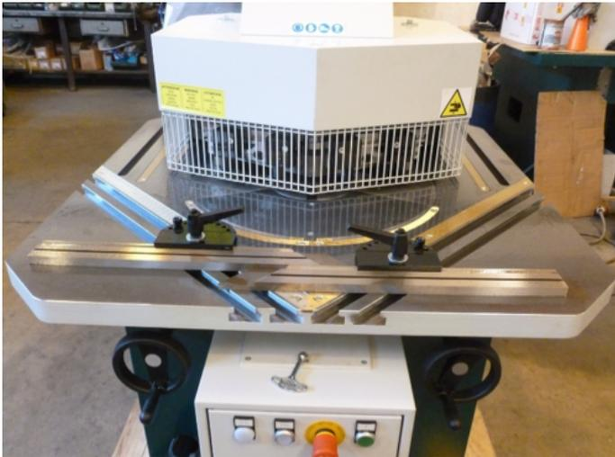
Il tavolo di lavoro è rigido e ampio, presenta aste millimetriche in alluminio incise a triplice funzione, per la misurazione delle varie tranciate. Grazie a robusti riscontri rettificati e ad aste millimetriche, l'operatore ottiene un posizionamento rapido e preciso del pezzo.
